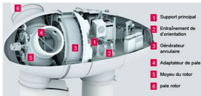
Vue intérieure d'une nacelle
